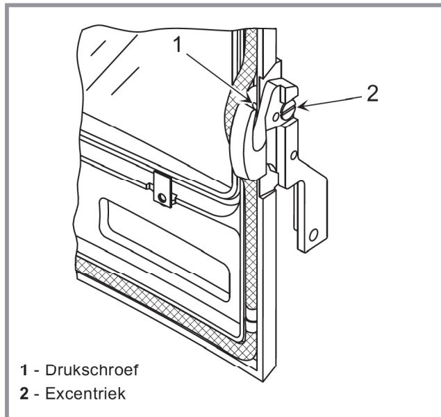
**Figuur 7 - Sluitdruk van de deur**
