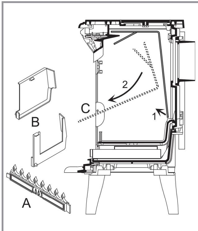
*Figuur 8 - De keerplaat uitschuiven*
