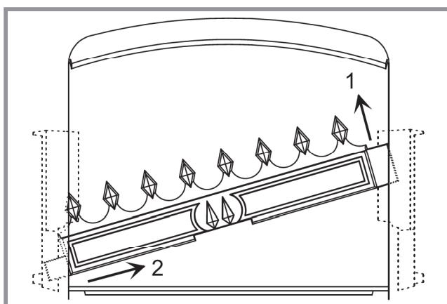
*Figuur 9 - Demontage van het voorste rooster*
