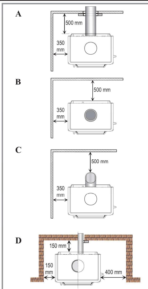
Figure 2 - Dégagement minimum d'installation
