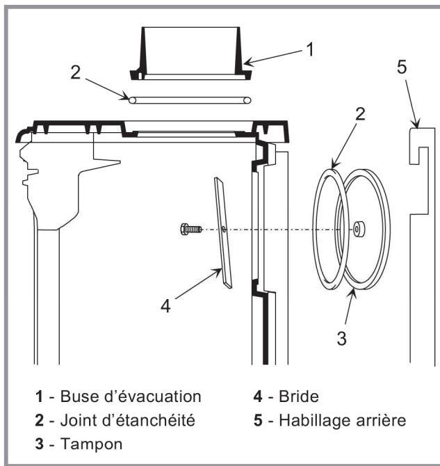
**Figure 3 - Départ des fumées au dessus**
